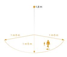
Mögliche Montagehöhe: 1,80 m – 2,00 m Orange: radial und tangential 3 skalierbare Achsen
