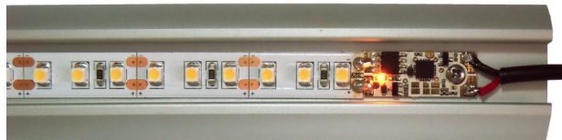
Obr. 4 - Ukázka instalace do profilu
